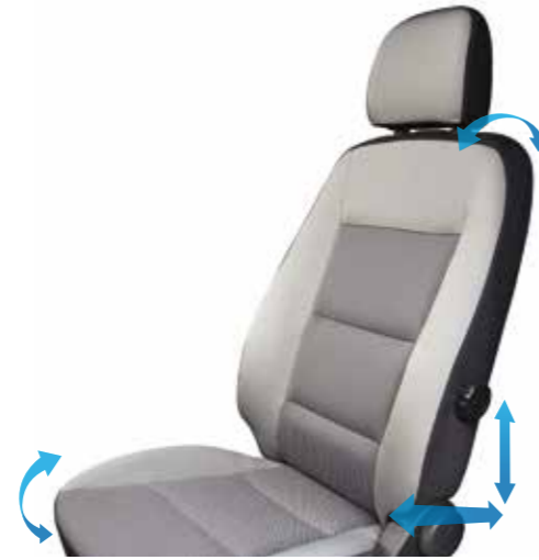
Optimalizált kialakítású vezetőülés A vezetőülést messzemenőig a preferált ülés helyzetre, illetve munkakörülményekre optimalizáltuk.
