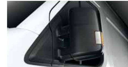
Tükörházba épített irányjelző (LED)
